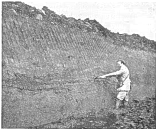
Kuva 14. Timahoe South. Noin 2.5 m syvä nostohauta. Sen reunassa on mr. Tom Barryn osoittamassa kohdassa hyvin maatunut LSt-kerros, joka on kuivuuksaan halkeillut.
