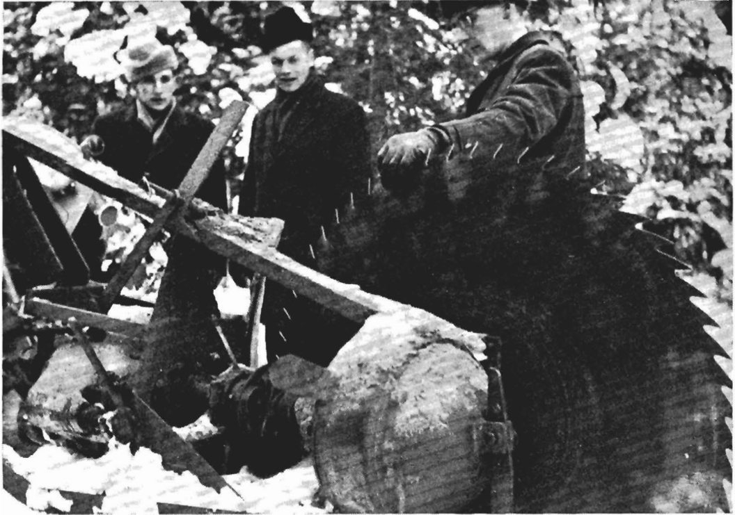
KUVA 4. Metsäojien talvikaiivua on yritetty helpottaa myös moottorisahoilla ja kuvan esittämällä, traktorin työkoneksi tarkoitetulla routasahalla. Täysin tyydyttävään ratkaisuun ei tällä linjalla ole vielä päästy. Valok. V. Ruokolahti.
