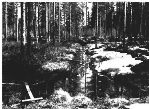
Kuva 5. Vasemmalla olevalla koerudulla pidetään pohjavedettä nostettuna syyskuusta kesäkuuhun. Vilppula. Koe 3.
