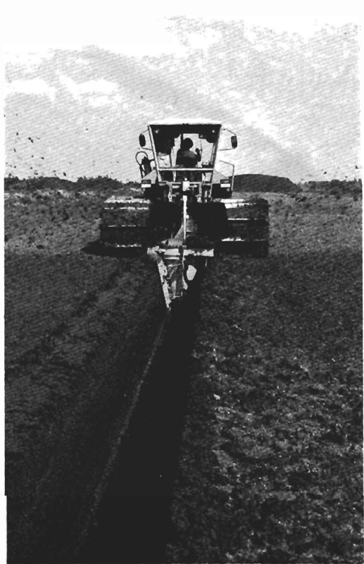
Kuva 3. Suon ojitusta jyrsimellä turpeen korjuuta varten. Aitoneva, Kihniö.
