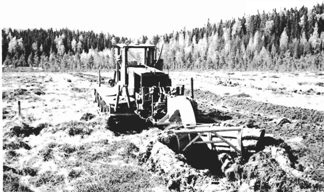
Kuva 1. Metsänviljelyaura m/Vehviläinen työssä Nuijanevan alueella. Takana Kopo-jyrsimellä tehtyä turvemurskapenkkiä.
