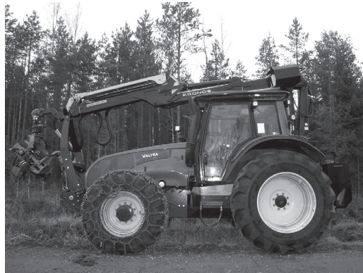
Kuva 1. Hakkuukoneeksi varusteltu Valtra T171-turvetuotantotraktori (Kuva: Juha Laitila/METLA)
